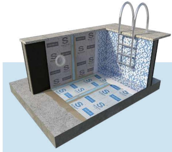
**Oxidación:** El sistema constructivo nos ayuda a proteger el hormigón ya que al ser de polipropileno nos crea una protección impermeable a todo tipo de aguas interiores y exteriores del vaso evitando que pueda haber un contacto con el acero y que pueda crear una corrosión.
